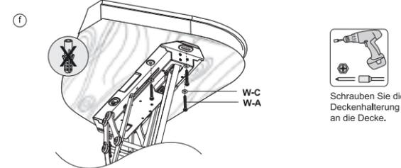
**1B. Befestigung an Vollziegel oder Beton**
