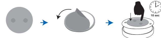
**c** Montieren des Rauchalarms an der Decke: Der Sockel des Rauchalarms wird einfach am Deckenelement platziert. (d) Um den Rauchalarm zu entfernen, ziehen Sie nicht vertikal nach unten, sondern vom Deckenelement seitlich weg.
