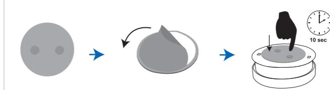
**c** Montaż czujki dymowej na suficie: Tylna część czujki jest umieszczana bezpośrednio na powierzchni elementu zamontowanego na suficie. Aby zdjąć czujkę, nie należy ciągnąć w dół, lecz lekko w bok przesuwając ku brzegowi podstawni zamontowanej na suficie.
