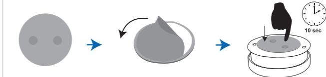
**c** Armado de la alarma de humo en el techo: La base de la alarma de humo se coloca simplemente en contra del elemento de techo. Para quitar la alarma de humo, no tire hacia abajo verticalmente pero deslizar hacia los lados del elemento de techo.
